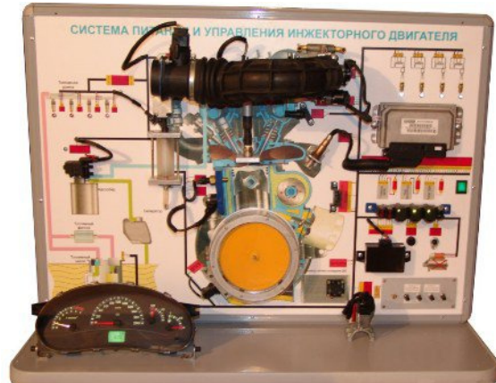
Рис. 3. Лабораторний стенд «Система керування інжекторного двигуна» автомобіля ВАЗ-1118 (E-mail: info@autolabstend.ru)
