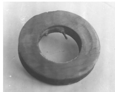
Рис. 4. Выход фронта затвердевания на внутренней поверхности заготовки за пределы дорна
